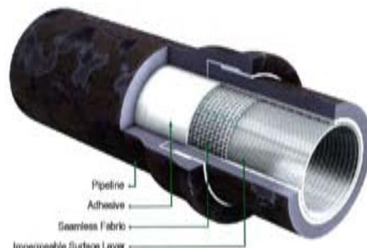
**Bild 6:** Verbundsystem bestehend aus vorhandener Rohrleitung und mit dessen Innenfläche vollflächig und dauerhaft verklebtem starline®-Gewebeschlauch aus hochfesten Garnen und undurchlässiger Beschichtung
