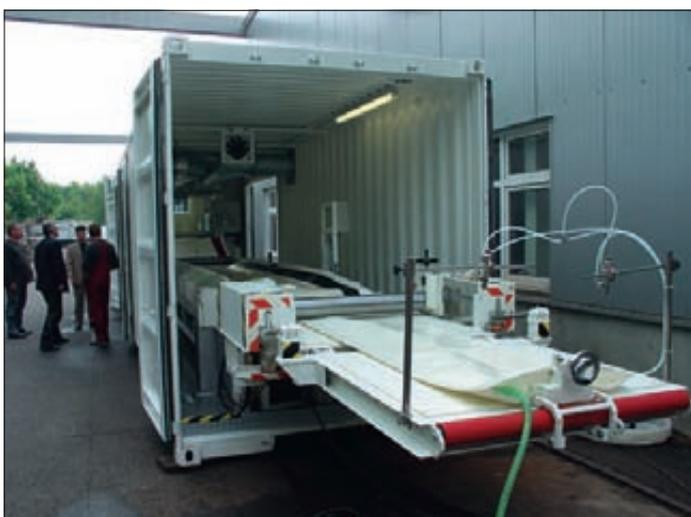
**Bild 5:** Klimatisierte Liner-Applikation mit Klebstoff-Einfüll- und Verteilungssystem
