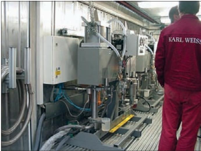
**Bild 4:** Blick in temperierten Klebstoffmisch- und Dosiercontainer
