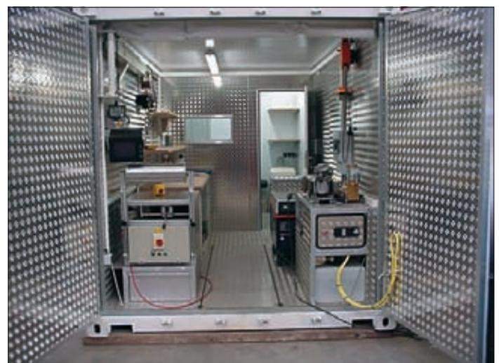
**Bild 3:** Ansicht des Systems zur TV-Inspektion und Kalibermessung mit Datenaufzeichnung für Inspektions- und Kalibermessfahrten bis 1000 m
